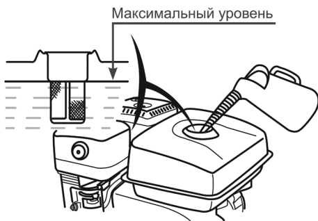
Рис. 20 Максимальный уровень топлива в топливном баке
