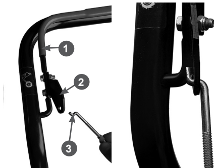
Рис. 7 Крепление наконечника троса включения хода
