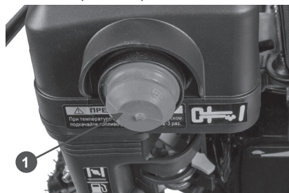
Рис. 26 Расположение ручного топливного насоса
