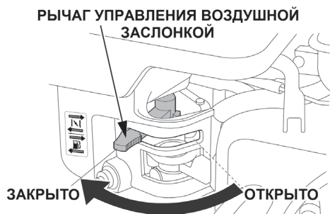
Рис. 22 Рычаг управления воздушной заслонкой
