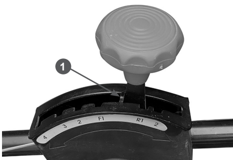
Рис. 11 Установка рычага в нейтральное положение
