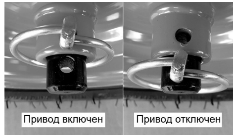
Рис. 27 Перестановка шплинта на левом колесе
